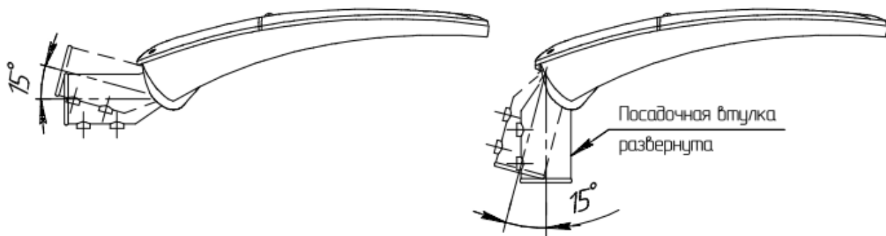
Рисунок 1.2 – Углы наклона светильника
